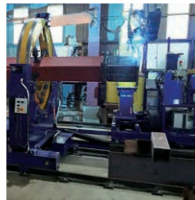
コアの連続溶接稼働
