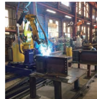
仕口連続溶接稼働
